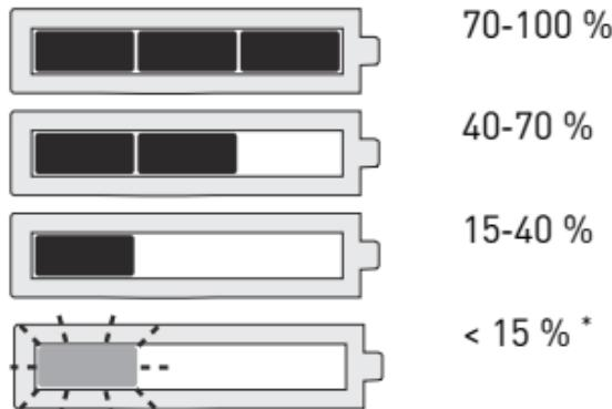
\* **Recommandation :** recharger la batterie avant de continuer à utiliser l'appareil.
